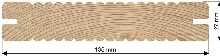
**27b** Sonderprofil geriffelt mit Steg ohne Seitenschlitz
