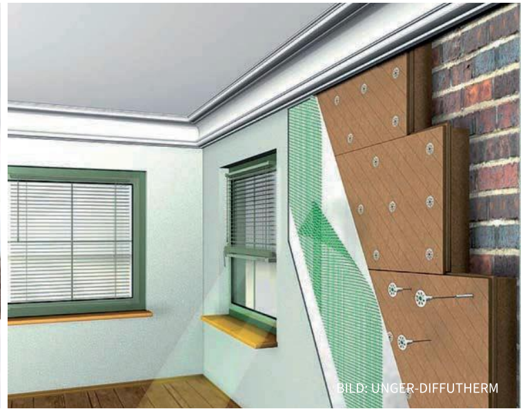
Beispiel für den Wandaufbau Dämmung mit Putzträgerplatte
